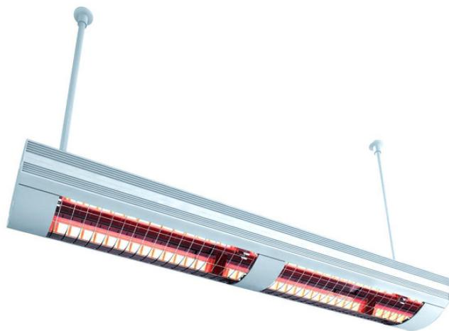
Sonderfarben auf Anfrage, praktisches Montagezubehör, hohe Effizienz, keine Aufheizphase, dimmbar über externe Regelung, Schutzart: IP 24, Prüfzeichen: VDE, CE konform, Spannung: 400 V, Festanschluss.
